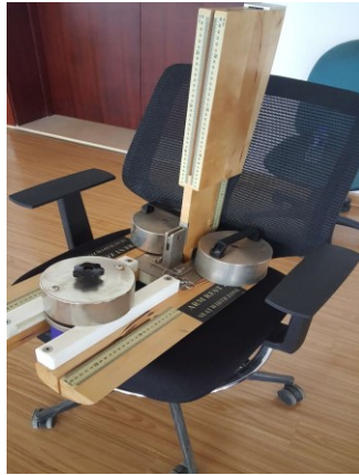
图 2 美国标准规定的办公椅尺寸测量装置
